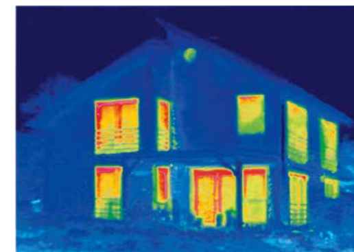
Les images infrarouges et la thermographie montrent clairement où se situent les pertes d'énergie dans une maison. Le rouge représente la chaleur et donc une perte d'énergie élevée.
